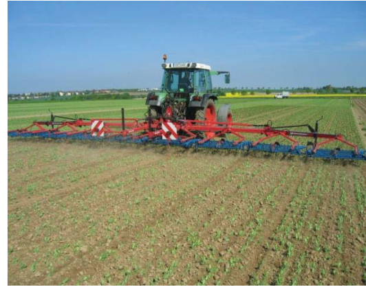
Abbildung 5: Versuche zur mechanischen Unkrautkontrolle mit einer Rollhacke (li. Bild) und einem Striegel (Quelle: JKI)
