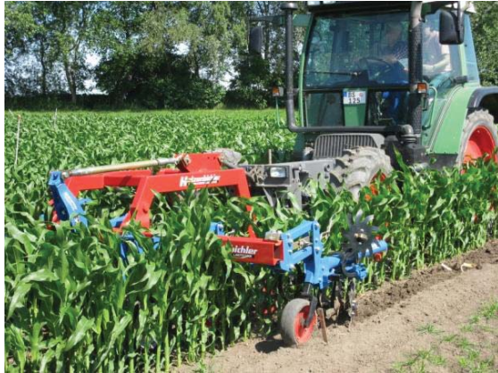
Abbildung 5: Versuche zur mechanischen Unkrautkontrolle mit einer Rollhacke (li. Bild) und einem Striegel (Quelle: JKI)
