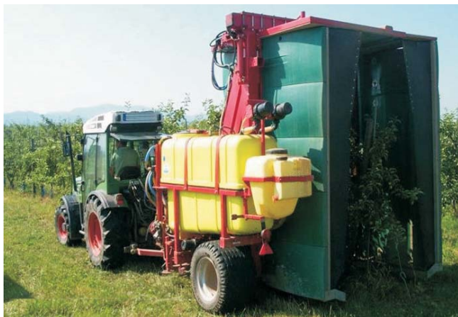
Tunnelspritzgerät im Obstbau zur Abtriftreduktion und Pflanzenschutzmitteleinsparung
