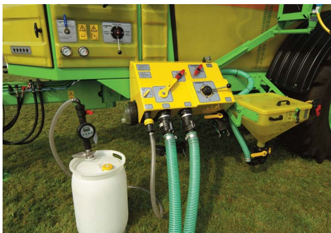
Zudosiergerät für Pflanzenschutzmittel
