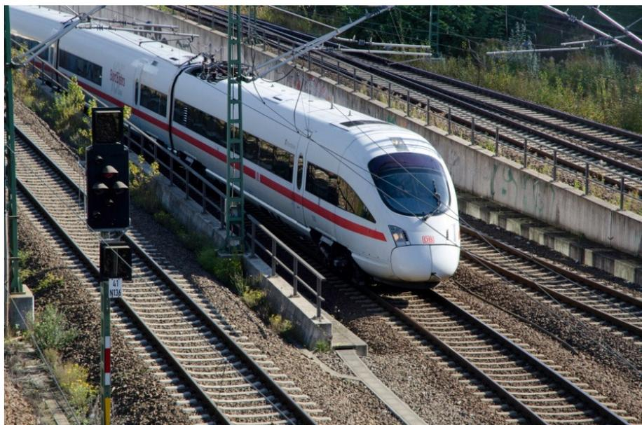
Die Gleisanlagen werden grundsätzlich in die folgenden Fahrwegkonstruktionen unterschieden, der traditionelle Schotteroberbau (s. a. Abbildung 4) und die Feste Fahrbahn. Die Betonkonstruktion der Feste Fahrbahn bzw. das Schotterbett mit dem Gleisrost bestehend aus Schienen, Schwellen und Befestigungsmitteln werden als Oberbau bezeichnet. Die Feste Fahrbahn
